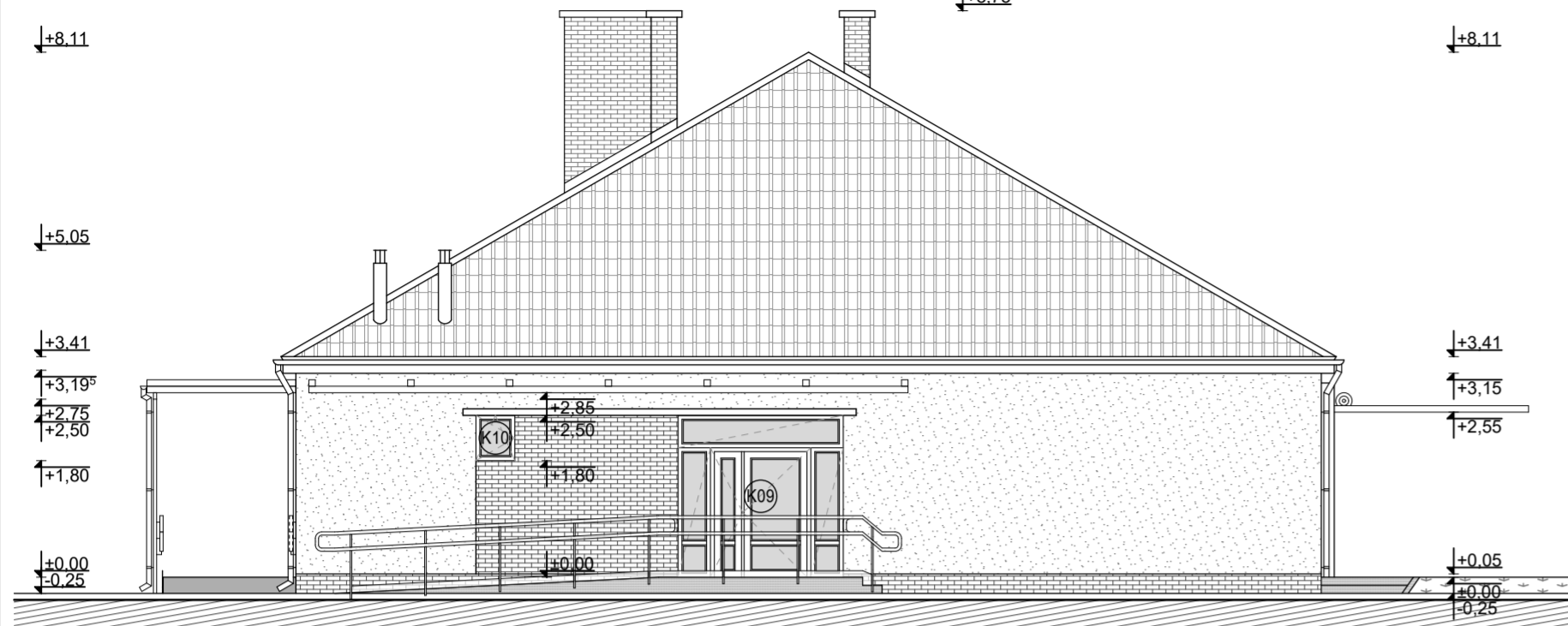
NYUGATI HOMLOKZAT M 1:100 tervezett állapot
